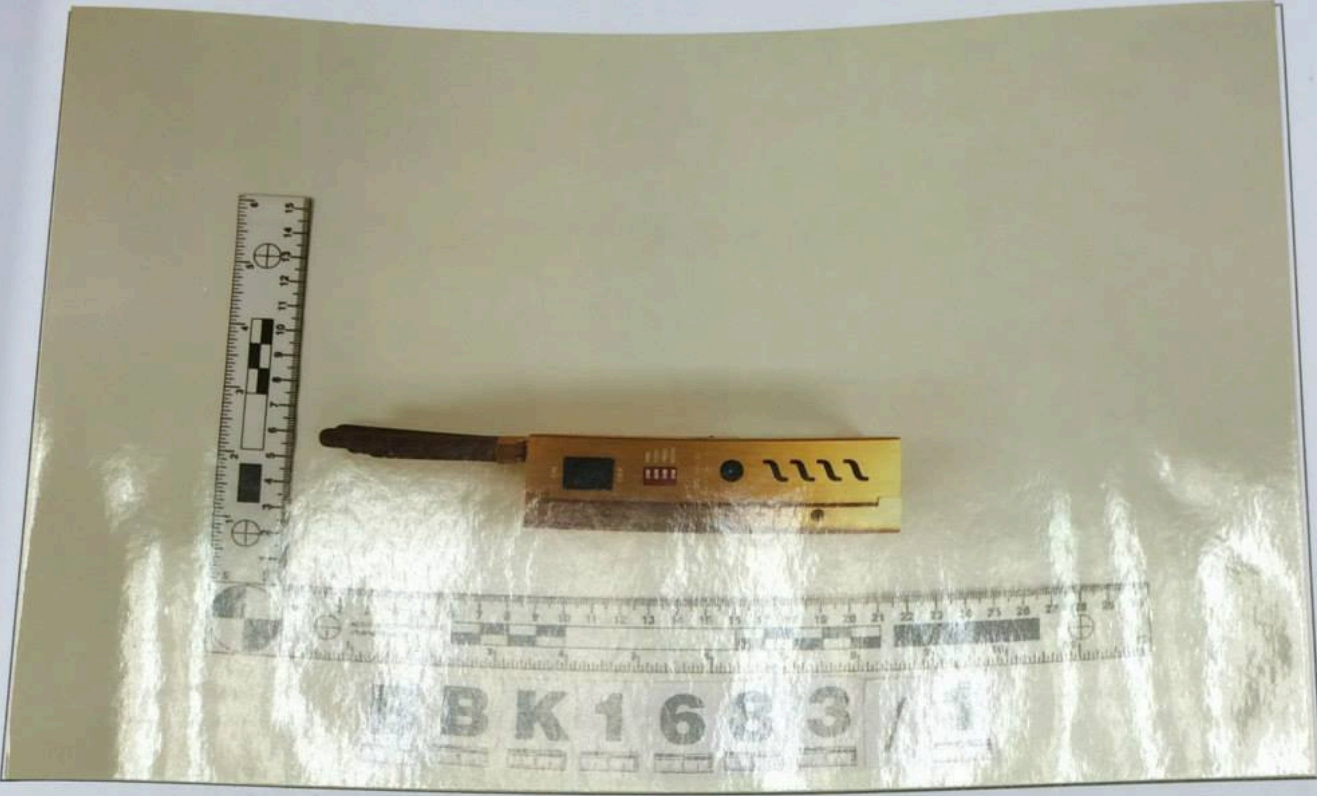
Fot. nr 7. Materiał dowodowy BBK1683/1 – urządzenie zagłuszające – wygląd ogólny.
